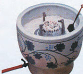
図16 瀬戸火鉢(草花模様) 従来の炭を使用する陶製火鉢と違和感なく使えるよう、陶製の外観や五徳、灰を備え、隅の代わりにお茶碗状のスケルトン(耐火粘土)を配置し、赤熱させて使用した。従来の火鉢と変わらぬよう、飾りとしてあえて灰を入れて使用することができた
