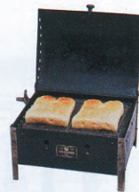
図12 2枚焼小型トースター/昭和30年 蓋を開けて鉄板の上にパンを置き、鉄板下のバーナーで焼き上げる。蓋を閉め、平置きで焼き上げるため、ピザトーストなども調理できた
