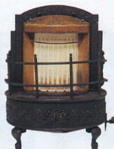
図14 60号曲面(国産)ガストーブ/昭和9年 片側6本ずつ、両面で12本のスケルトン(耐火粘土)を円筒状に並べたストーブ。日本オリジナルデザインのガストーブで360度放射状に放熱することができた
